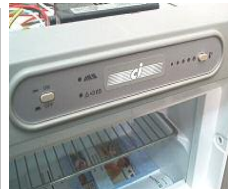
Pannello frigo con AES FOTO 20
