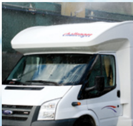
Simulateur recréant les conditions de roulage ou de stationnement sous la pluie, permettant d'effectuer des tests intensifs d'étanchéité.
