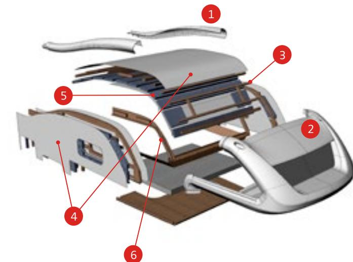
La capucines Arca offrent les meilleures prestations en termes d'isolation ; les panneaux isolants, le revêtement en matériaux composites et la circulation d'air dans les passages de l'air pulsée protègent contre le froid, la chaleur et les rumeurs extérieurs. De nombreuses ouvertures assurent la luminosité et un constant recharge d'air.
