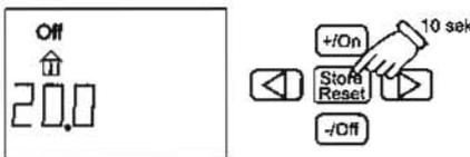
2 Il pannello di controllo mostra che la caldaia è "off". Il GPL è "on". Il gruppo di riscaldamento elettrico a 230 V è "on" a 1 kW. Viene visualizzata anche la temperatura ambiente.
